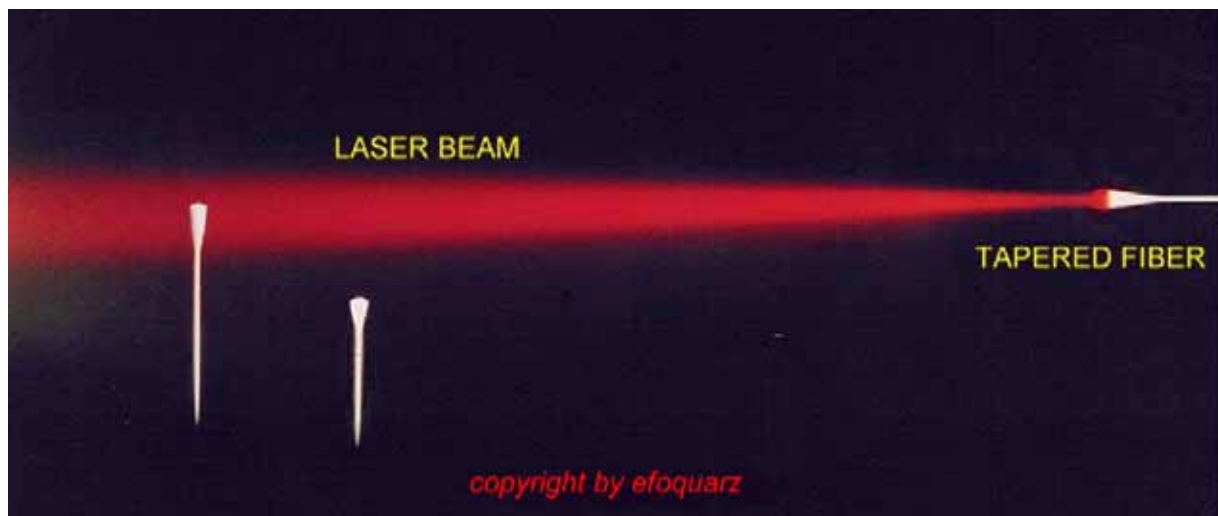
Bild 1 Der gebündelte Laserstrahl und der Taper mit integrierter Mikrolinse sind gut zu erkennen. Die Entfernung zwischen dem Taper mit dem roten Laserstrahlaustritt und dem mit Tageslichtbeleuchtung beträgt genau 100 mm.
