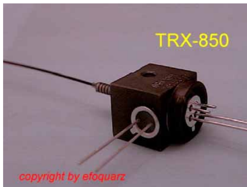
Abb. 6 IMO Komponenten, Verbindungseinheit und Sender/Empfänger
